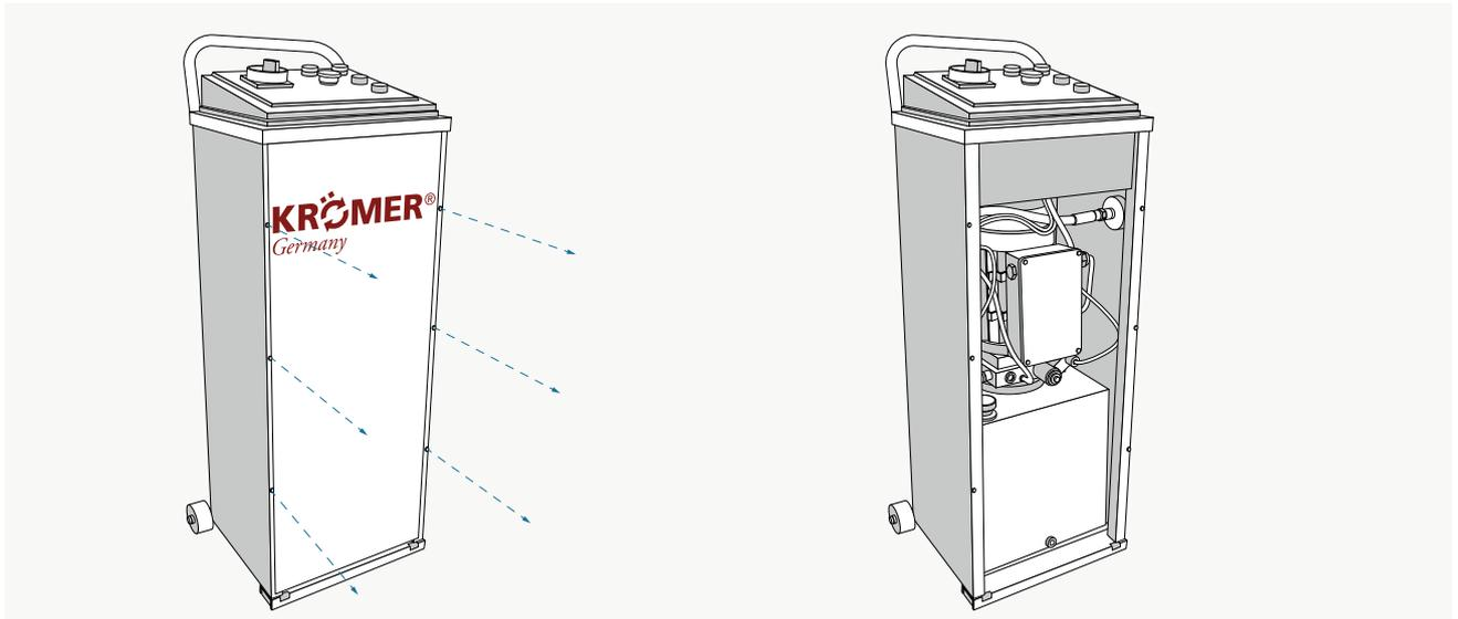
Öffnen Sie das Bedienpult durch Lösen der Schrauben.
