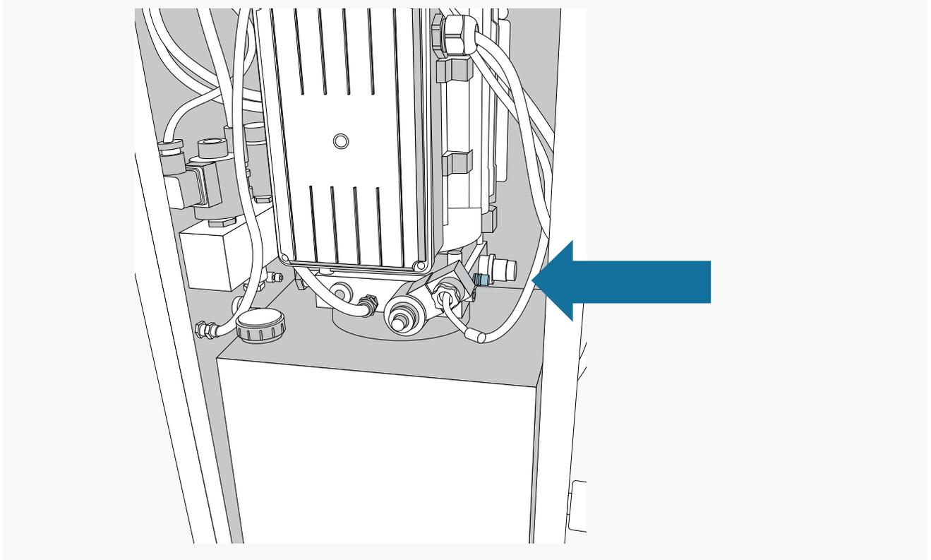
Das kleinere Ventil (Drosselungsventil) an der rechten Seite innen im Bedienpult ist für die Hubkraft zuständig. Dreht man es zu, wird mit mehr Hubkraft gehoben, dreht man es auf, wird mit weniger Hubkraft gehoben.
