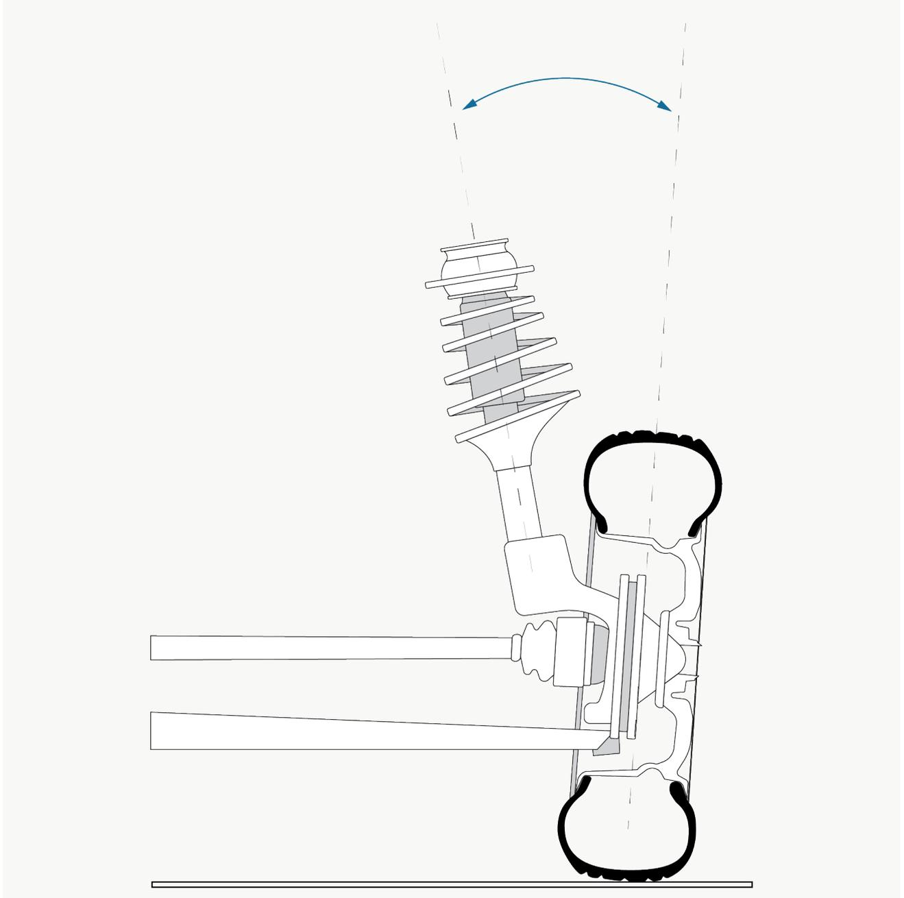
Der SAI oder auch K.P.I (Kingpin Inclination Angle) Wert beschreibt den Winkel, um den die Autoräder nach dem Lenkvorgang automatisch wieder in die gerade Spur kommen. Je größer der Neigungswinkel, desto stärker ist der Rücklauffeffekt. Ein größerer Rücklauffeffekt erfordert mehr Aufwand beim Drehen des Lenkrades und führt zu einem höheren Verschleiß der Reifen. Mit der Einstellung eines korrekten SAI Wertes kann die Lenkung erleichtert und somit der Verschleiß der Reifen vermindert werden.
