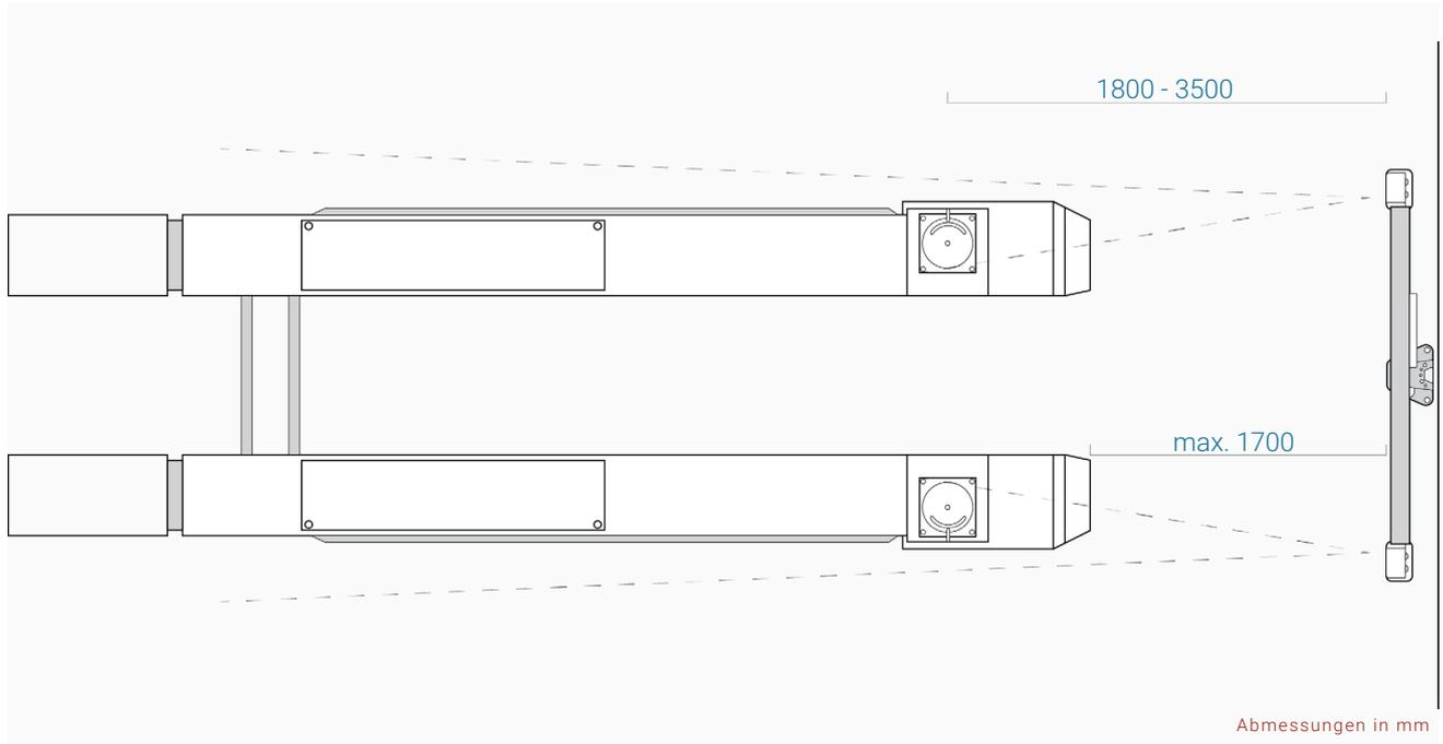
Der Abstand zwischen Bühne und Achsenvermessung darf maximal 1,70 Meter betragen.
