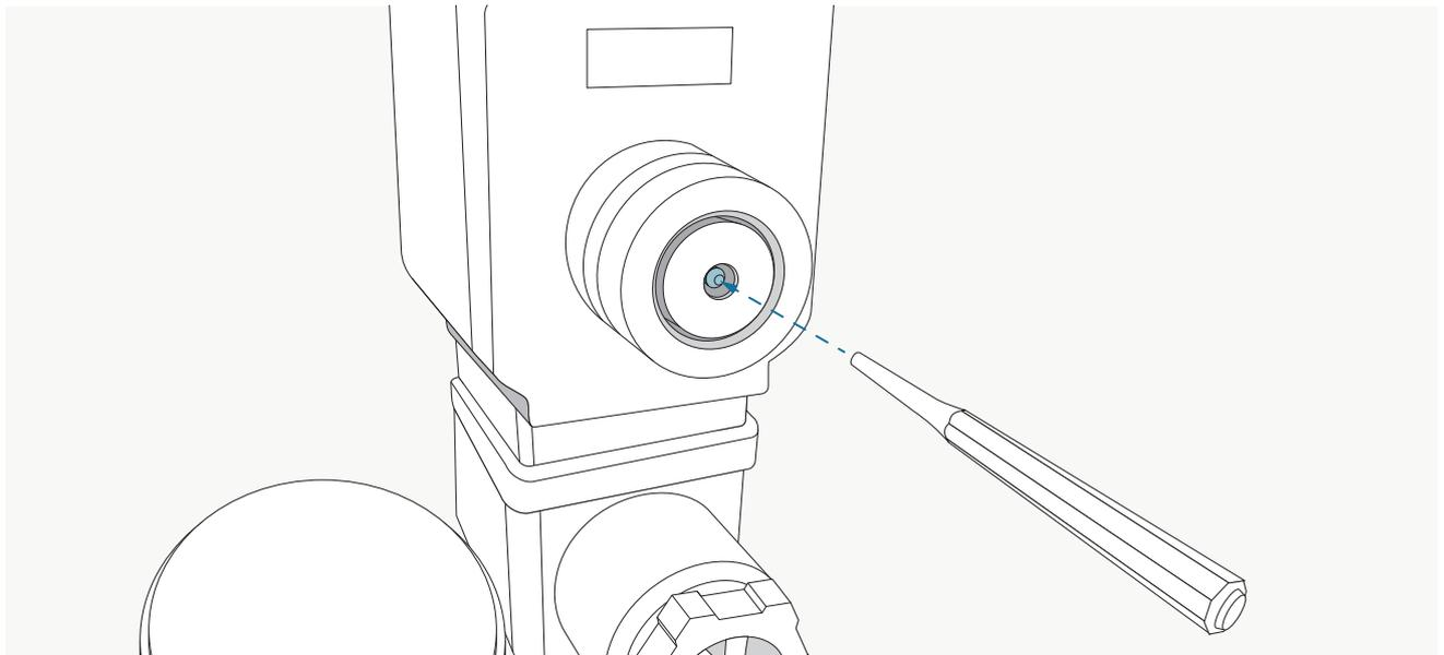
Bei dem Ventil auf der rechten Seite handelt es sich um das Ventil für die Nebenzylinder, dieses muss zuerst eingedrückt werden. Hierfür eignen sich beispielsweise ein flaches Schlageisen oder ein kleiner Inbusschlüssel.
