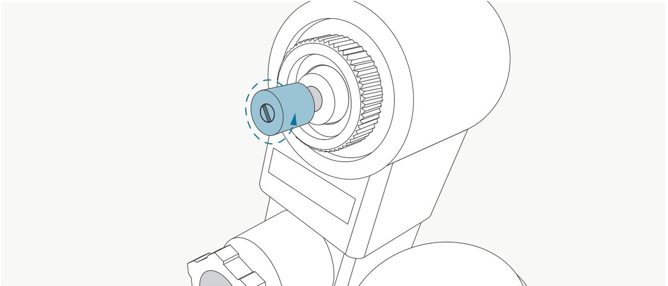
Während das Nebenventil eingedrückt wird muss das Ventil für die Hauptzylinder **langsam** geöffnet werden. Hierfür muss der Drehverschluss vorsichtig linksherum gedreht werden. Die Plattformen sollten nun langsam (entsprechend der Öffnung des Hauptventils) absenken.
