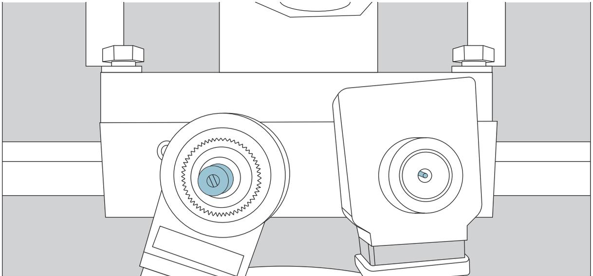
Zum lokalisieren der Ablassventile muss die Tür des Bedienpults geöffnet werden. Sie befinden sich direkt über dem Tank.
