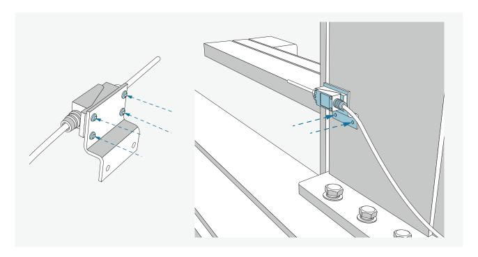
Befestigen Sie die Halterung mit vier Schrauben an der Rückseite des CE-Schalters und schrauben Sie ihn anschließend an die untere linke Seite der Säule.
