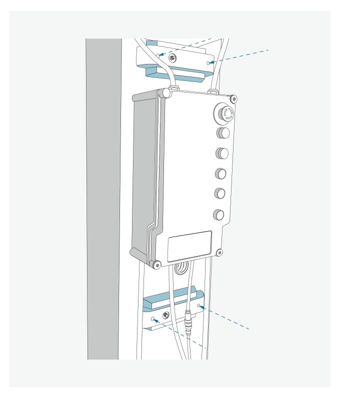
Anschließend die Abdeckungen der Elektromagnete anschrauben.
