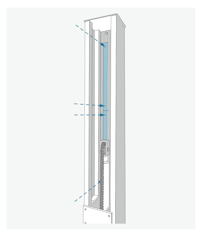
Sind die Kabel verlegt kann der Kabelkanal wieder angeschraubt werden.
