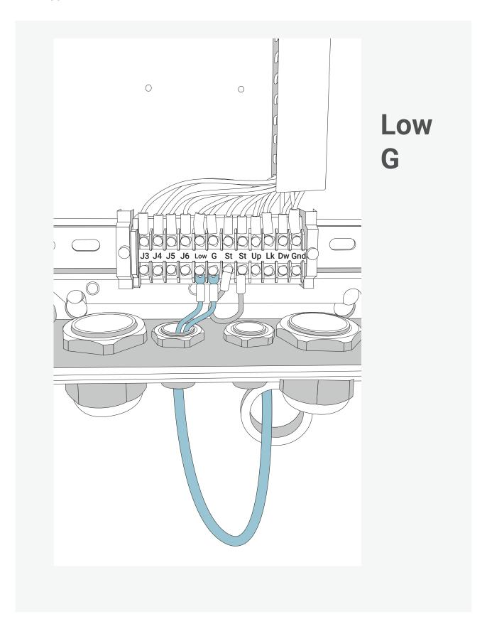
Die Anschlüsse des CE-Stopp-Schalters durch die linke Öffnung vom Bedienpult unten durchführen und an die vorgesehenen Steckplätze anschließen.
