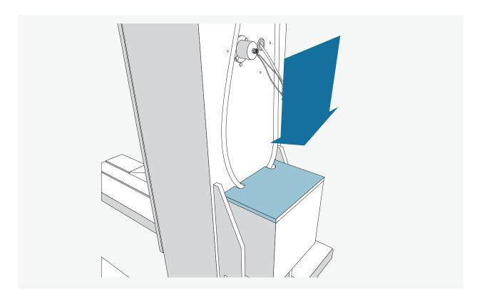
Anschließend setzen Sie den Deckel auf den Batteriekasten,.
