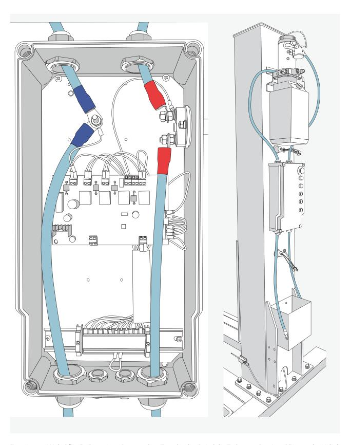
Es müssen 4 Kabel für die Batterie verlegt werden. Entscheidend sind die Farben an den Anschlüssen der Kabel. Die Kabel haben unterschiedliche Längen, das längere Kabel geht zum Motor, das kürzere zur Batterie
