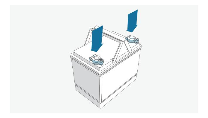
Bevor Sie die Batterie einsetzen, setzen Sie die Klemmen an die Kontakte der Batterie, ggf. muss die Batterie vor dem Einsetzen aufgeladen werden.
