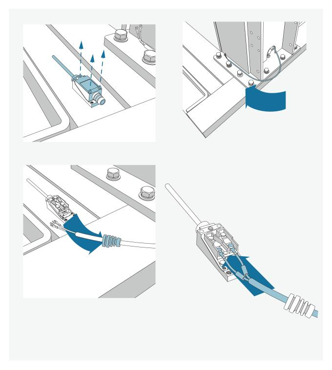
Schrauben Sie zuerst die obere Abdeckung des CE-Schalters auf, führen sie anschließend den Kabelschutz über die aus der Säule kommenden Anschlüsse "Low"/"G" und Schrauben sie die Anschlüsse an die unteren beiden Steckplätze. Schrauben Sie anschließend die Abdeckung wieder auf den CE-Schalter.
