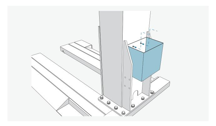
Schrauben Sie mithilfe von zwei Schrauben den Halterungskasten der Batterie außen an die Bühne.
