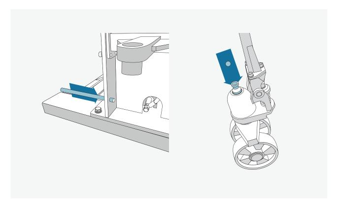
Setzen Sie den Bolzen an, an welchem der Hubwagen befestigt wird. Setzen Sie die Kugel in das Kugellager des Hubwagens.
