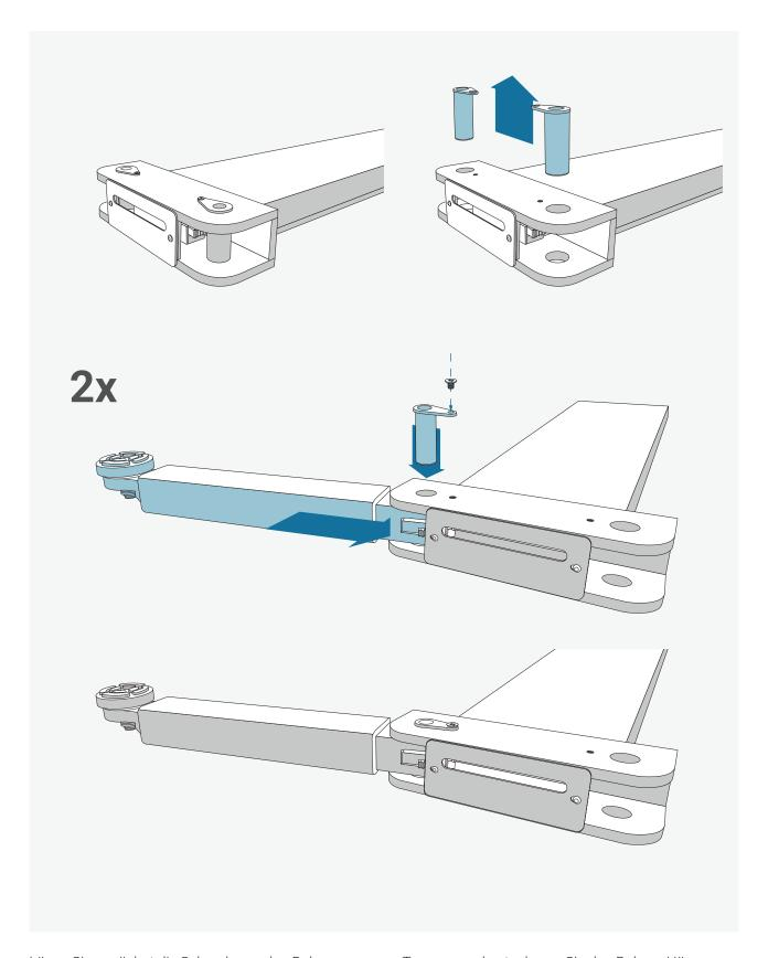
Lösen Sie zunächst die Schraube an den Bolzen vorne am Tragarm und entnehmen Sie den Bolzen. Hängen Sie anschließend die Tragarme ein und fixieren Sie diese anschließend wieder mit den Bolzen und der Schraube.
