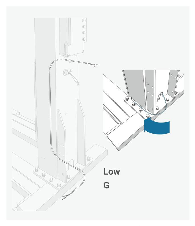
Die Anschlüsse Low/G gehören zum unteren CE-Schalter und müssen durch die Öffnung unten aus der Säule auf die linke Seite verlegt werden.
