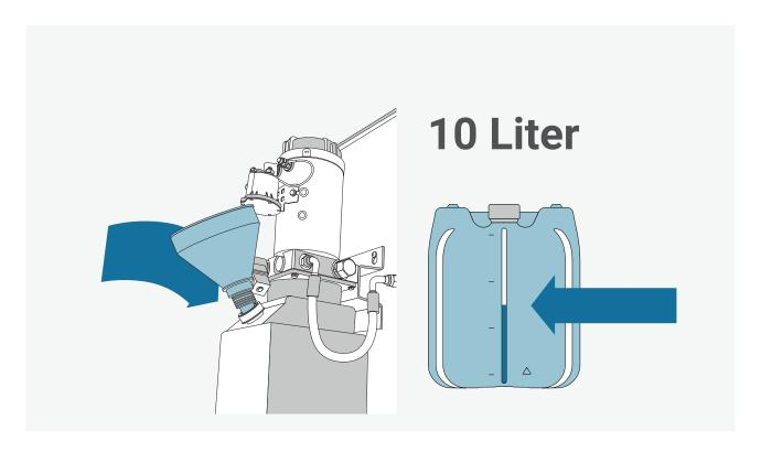
Ist der Motor angeschlossen, kann per Trichter Hydrauliköl in den Tank gefüllt werden. Ca. 10 Liter HLP46.
