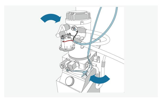
Gleiche Prozedur für die Anschlüsse vom Ablassventil (J3/J4). Die Runden Kontakte der Kabel J7/J8 nach den Farben der Kabel wie darsgestellt anschließen.
