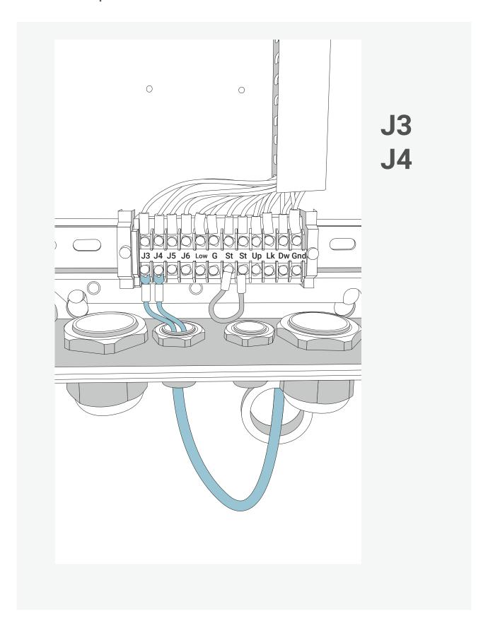
Die Anschlüsse des Ablassventils durch die linke Öffnung vom Bedienpult unten durchführen und an die vorgesehenen Steckplätze anschließen.
