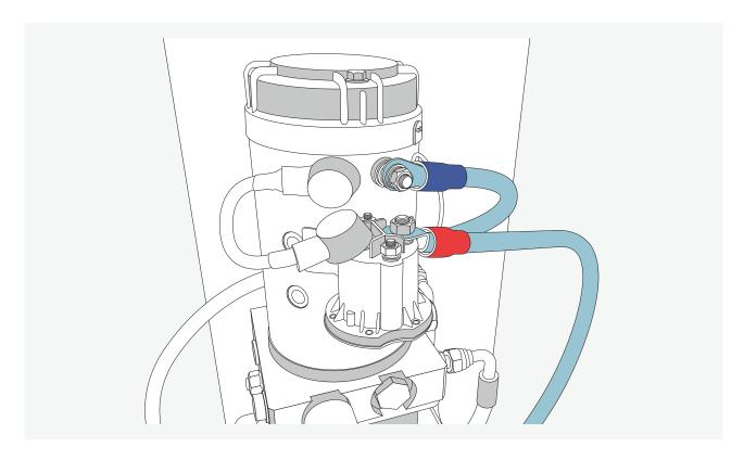
Schließen Sie die Kabel wie dargestellt an den Motor an.
