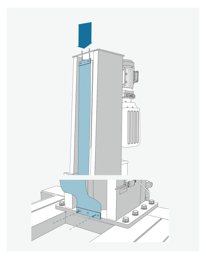
Befestigen Sie dden Sichtschutz der Säulen oben sowie unten an der Säule, zwischen Tragarm und Säule.
