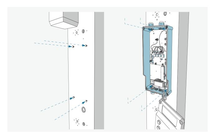
Schrauben Sie wie beim Motor zuerst die Schrauben in die Säule und hängen Sie das Bedienpult an die Säule. Anschließend können die Schrauben festgeschraubt werden.
