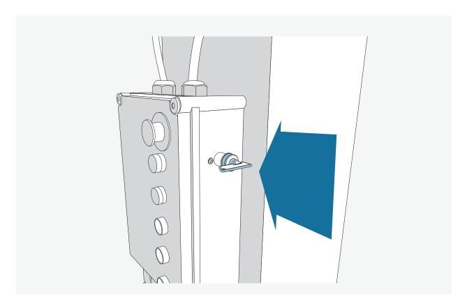
Anschließend den Startschalter an das Bedienpult stecken.
