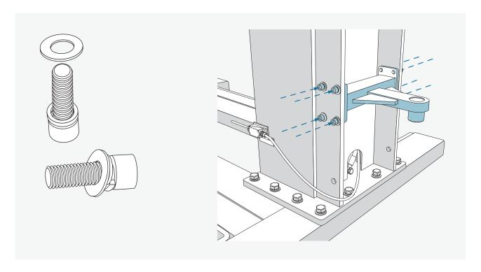
Die Kopplung mit Sperring und Distanzscheibe an der Rückseite der Säule anschrauben.
