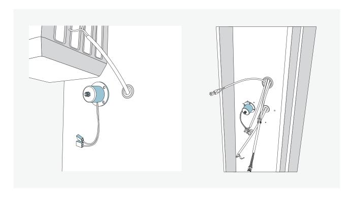
Auf der äußeren Seite der Säule werden die Elektromagneten mit vier Schrauben angeschraubt.
