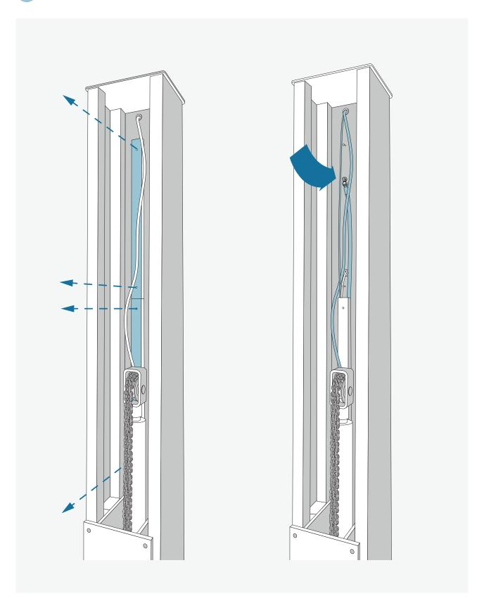
Lösen Sie die Schrauben vom Kabelkanal und lösen Sie die Abdeckung um die Kabel im Säuleninneren freizulegen. Verbinden Sie den Hydraulikschlauch mit dem oberen Verbindungsstück zum Motor.
