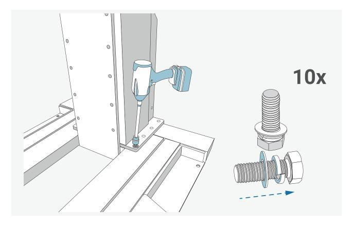
Säule befestigen und vorerst locker anschrauben.
