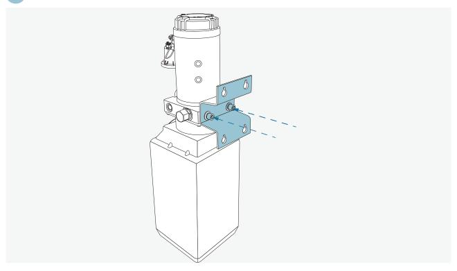
Halterung am Motor befestigen.
