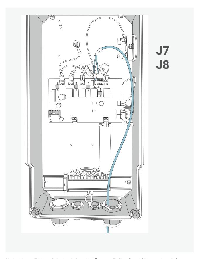
Die Anschlüsse J7/J8 vom Motor durch die rechte Öffnung am Bedienpult durchführen und anschließen.
