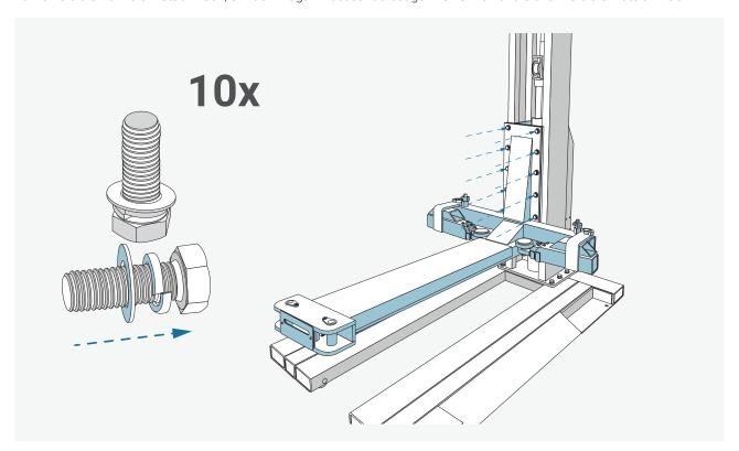
Schrauben Sie den Tragarm zunächst locker an die Bühne. Benutzen Sie Distanzscheibe und Sperring wie dargestellt. Anschließen diagonal die Schrauben festziehen.
