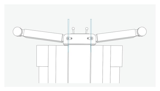
Prüfen Sie den Abstand des Tragarms zu der Bodenplattform der Hebebühne. Der Abstand muss auf beiden Seiten gleich sein.
