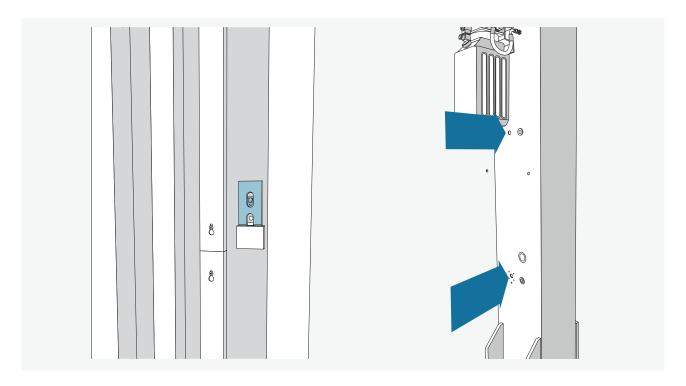
Setzen sie Sicherheitsraste und Elektromagnet beidseitig ein, befestigen Sie dann die untere Schraube am Magneten mit der Raste.
