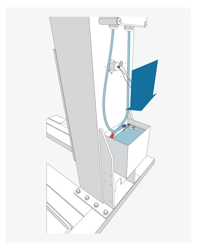
Die Batterie in den Kasten einsetzen und die Batteriekabel wie dargestellt an die Batterie anschließen.
