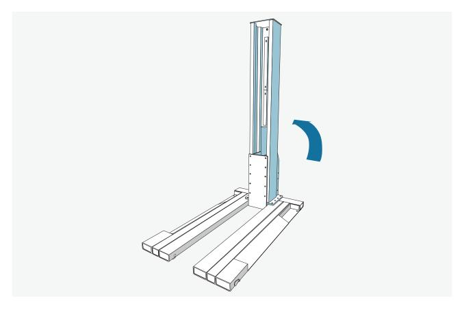
Säule über der Plattform positionieren und aufstellen.
