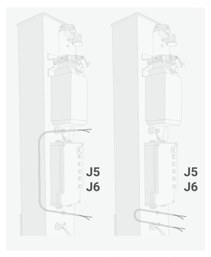
Die Anschlüsse J5/J6 gehören zu den Magnetschaltern der Sicherheitsraste. Es müssen jeweils zwei verlegt werden.
