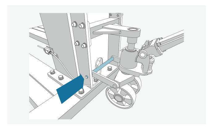
In der Kopplung befestigt, schieben Sie den Bolzen durch die beiden Arme des Hubwagens um ihn an der Säule zu befestigen. Anschließend auf beiden Seiten Sperring einsetzen.
