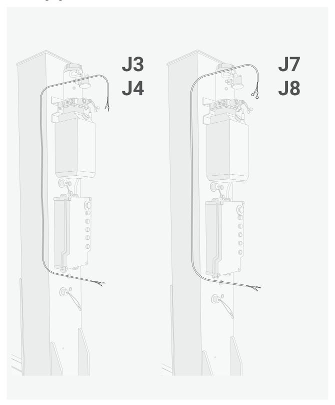
Verlegen Sie die Kabel aus dem unteren Teil des Kabelkanals durch die Öffnungen der Säule. Kabel mit den Anschlüssen J3/J4 gehören zum Ablassventil. J7/J8 gehören zum Motor. Beide kommen durch die gleiche Öffnung der Säule oben am Motor und unterhalb des Bedienpults.
