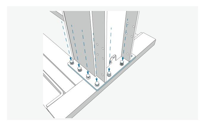
Jeweils an beiden Seiten vier und an der hinteren Seite zwei Schrauben befestigen. Schrauben immer diagonal anziehen, jedoch erst komplett festziehen sobald der Tragarm die richtige Position hat (siehe Ende der Anleitung)
