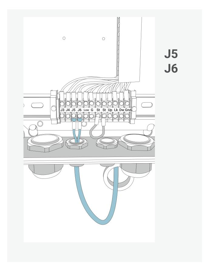
Die Anschlüsse J5/J6 von der Magnetspule/der Sicherheitsraste durch die zweite Öffnung von rechts unten am Bedienpult durchführen und anschließen.
