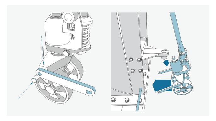
Schrauben Sie die Arme an beide Seiten des Hubwagens mithilfe der beiden Bolzen und setzen Sie ihn anschließend in die Kopplung.
