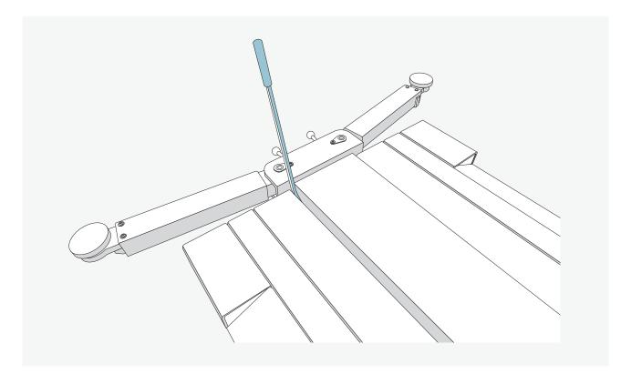
Ist er nicht gleich, gleichen Sie den Abstand durch Verschieben der Säule. Ist der Abstand gleich, befestigen Sie die Schrauben am Säulenfuß und ziehen Sie diese fest.
