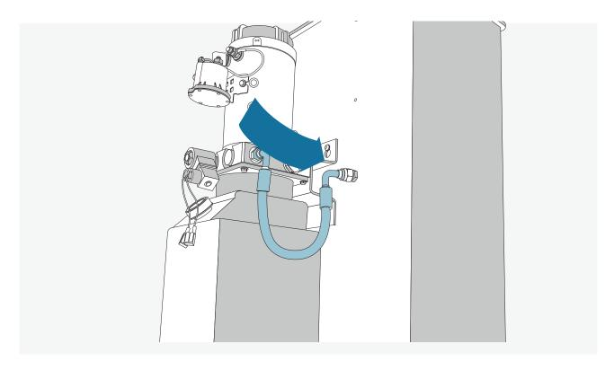
Den kleinen Hydraulikschlauch an Motor und Säule anschließen.
