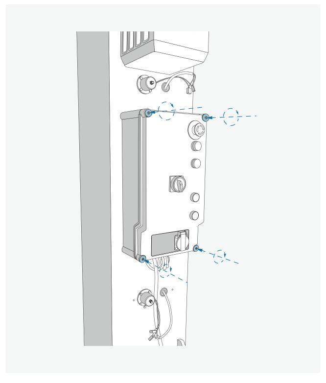
Nach Anschluss aller Kabel das Bedienpult wieder verschließen.
