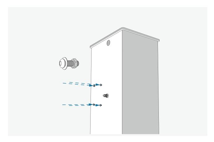
Um den Motor an die Säule anzubringen zunächst die Schrauben mit Distanzscheibe in die Säule einsetzen...
