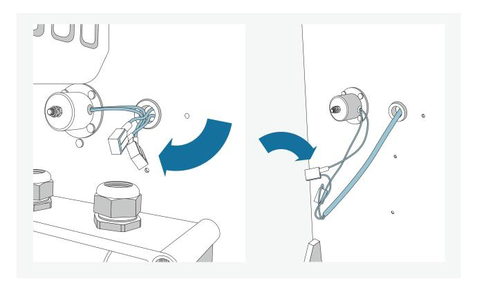
Knipsen Sie die Kabel der Elektromagnete (Anschlüsse J5/J6) ab und stecken Sie sie in die WAGO-Klemmen.
