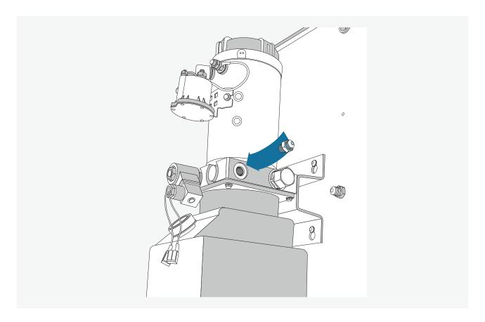
Anschließend den Hydraulikanschluss am Motor befestigen.
