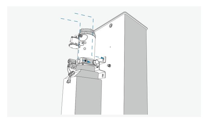
... und anschließend den Motor einhängen, und die Schrauben festschrauben.
