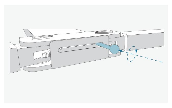
Die rote Kugel des Griffs an den Hebel schrauben und den Hebel anschließend an den Tragarm schrauben. (2mal).
