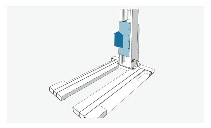
Fahren Sie die Bühne ein Stück hoch, um den Tragarm besser befestigen zu können und sichern Sie die Plattform ab.
