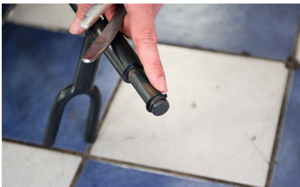
Position des Sicherungsring nach der Rollenmontage.
