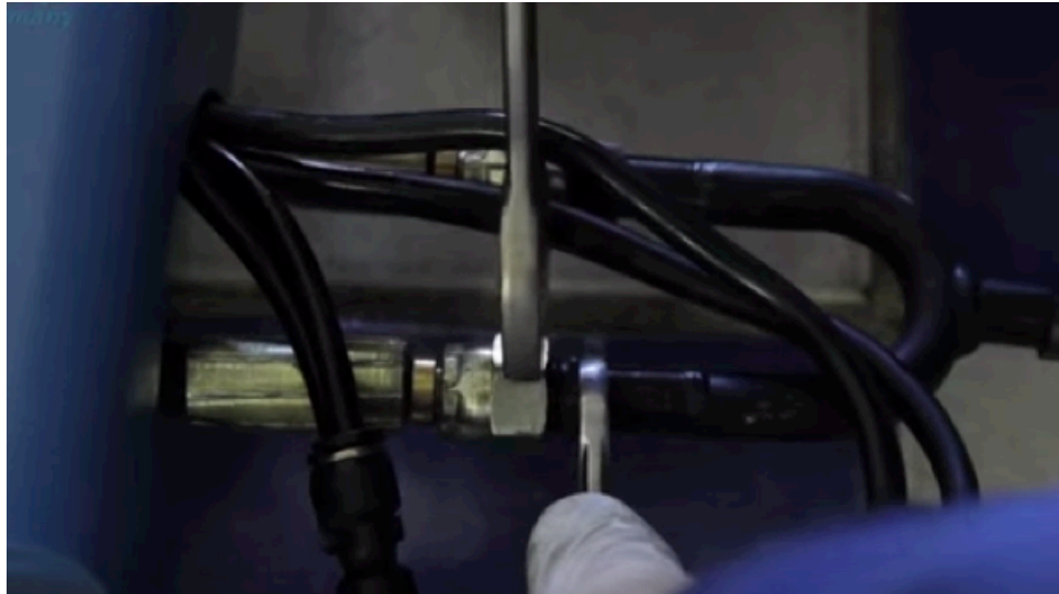
Anschrauben des Y-Stückes innerhalb des Bedienpults
